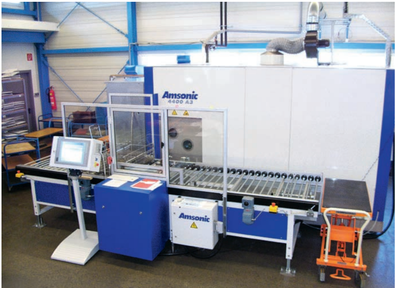
Bei dem Beschichtungsdienstleister Eifeler hat sich die AIII-Anlage zur Feinstreinigung von Werkzeugen vor der Beschichtung bewährt
